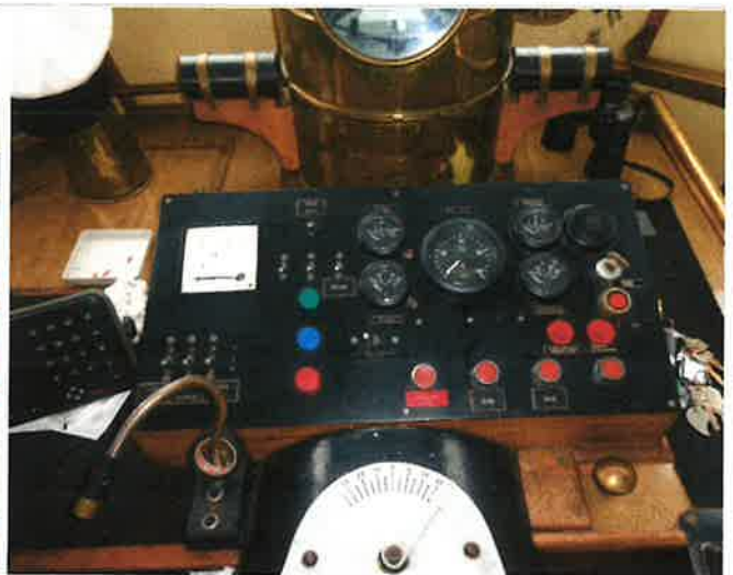
14. Panel kontrolny SG, wskaźnik steru
