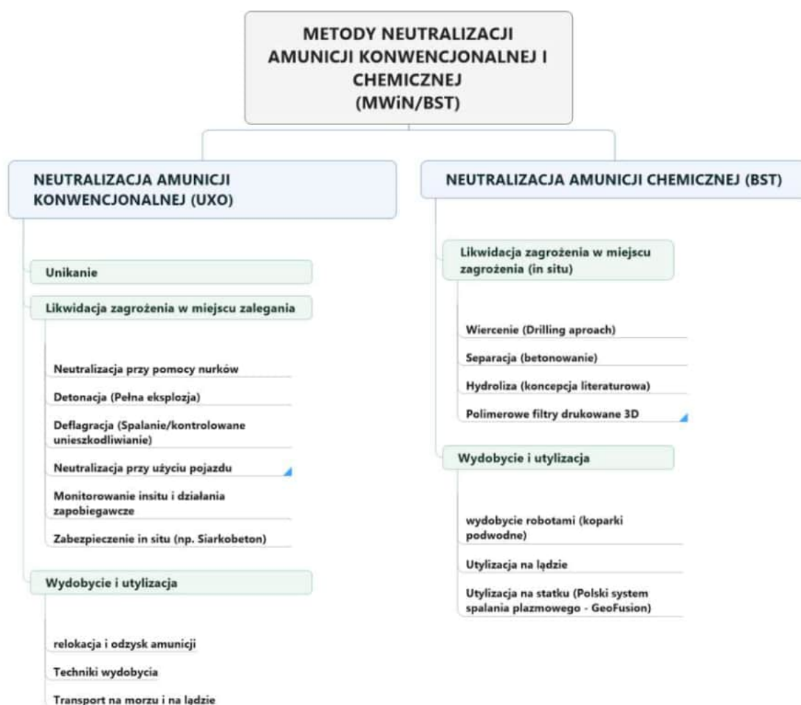
Rysunek 18 Diagram Metod Neutralizacji amunicji konwencjonalnej i chemicznej
