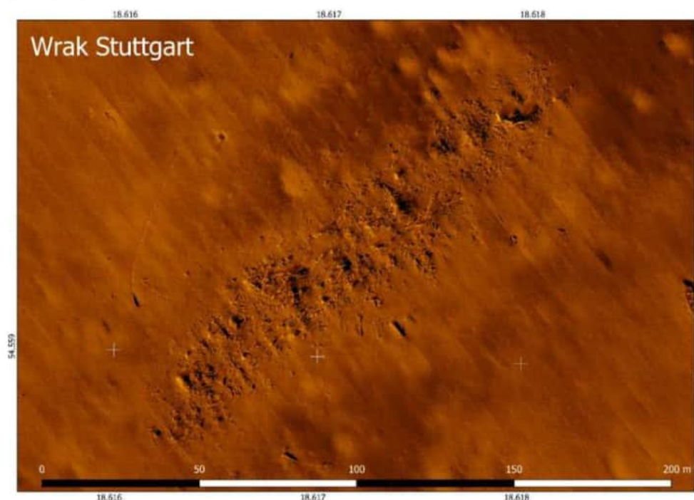
Rysunek 22 Mozaika sonarowa wraku wysokiej rozdzielczości wraku Stuttgart (2025)
