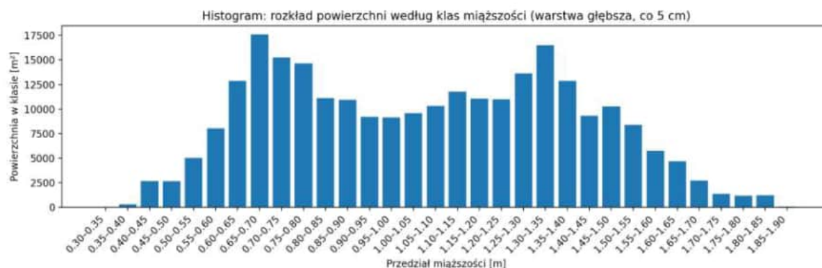
Rysunek 14 Histogram rozkładu powierzchni (ang. Planar Area) w klasach miąższości co 0,05 m dla interpretowanej warstwy głębszych osadów dennych (izopacha oparta na założeniach interpretacyjnych ze względu na słabą jakość danych akustycznych).
