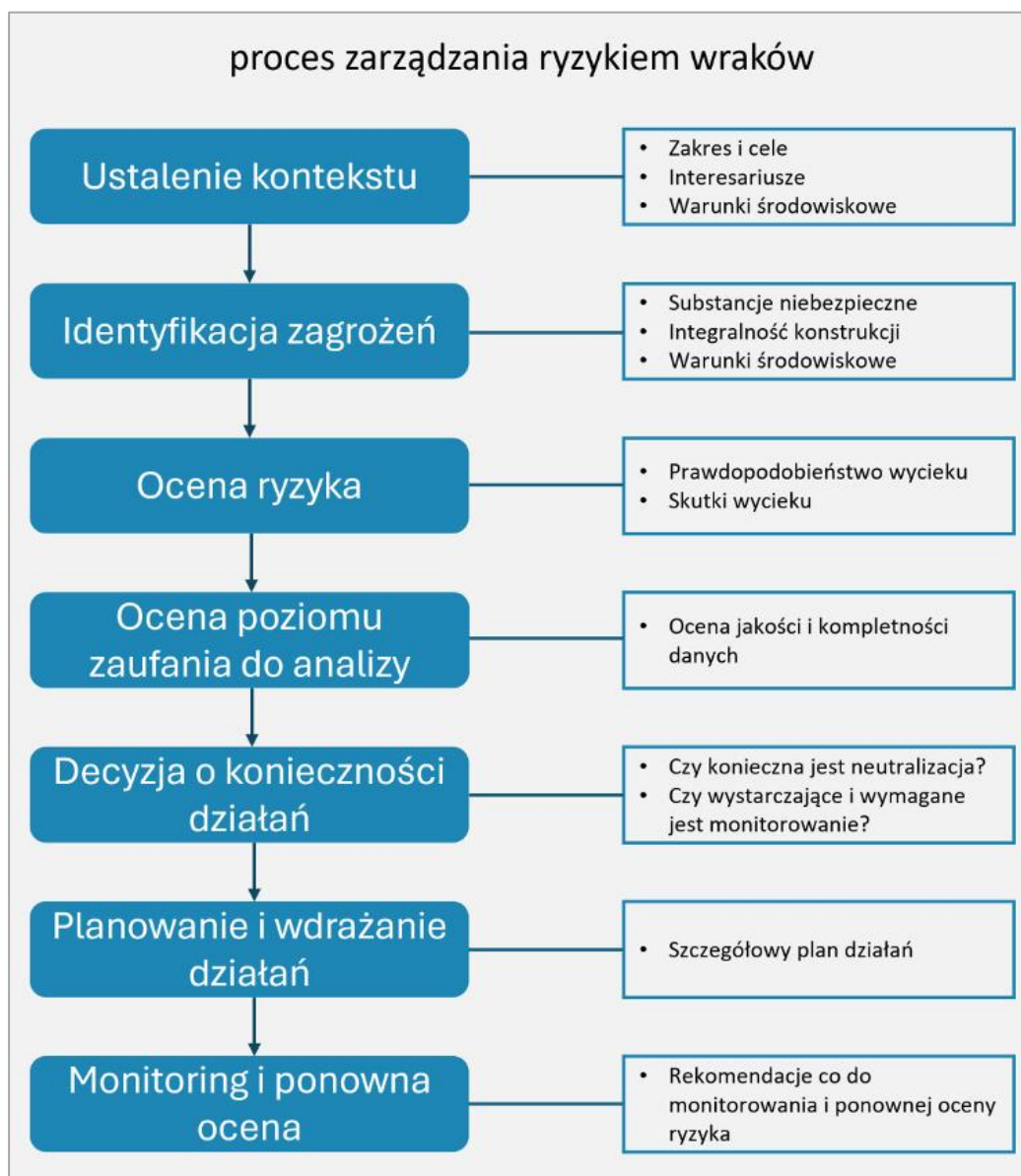
Rysunek 11. Schemat procesu zarządzania ryzykiem w odniesieniu do wraków (źródło: opracowanie własne)
