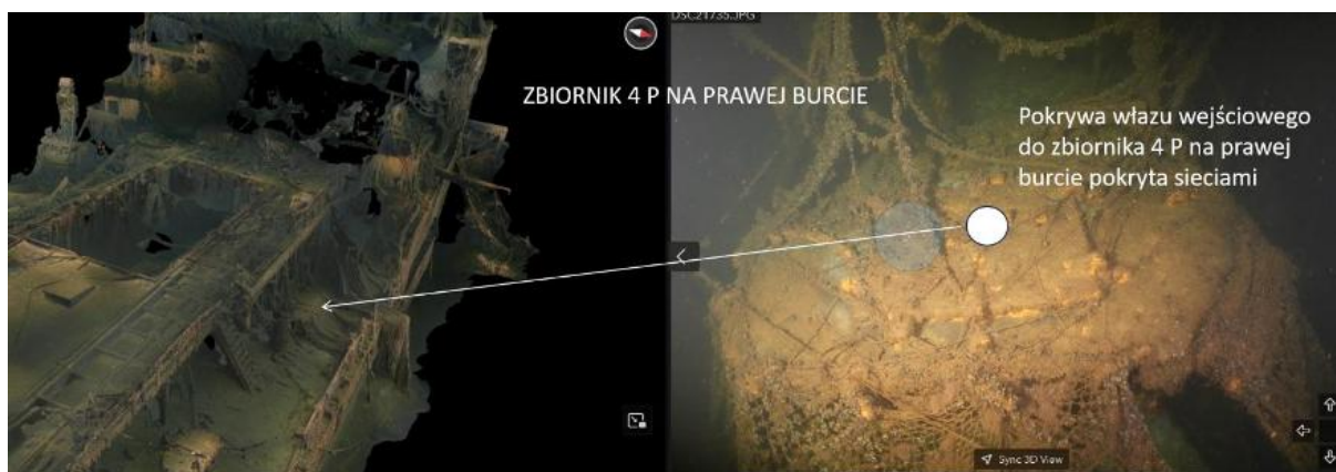
Rysunek 29. Dostęp do zbiornika ładunkowego 4P (źródło: opracowanie własne na podstawie Badania 2025-26)
