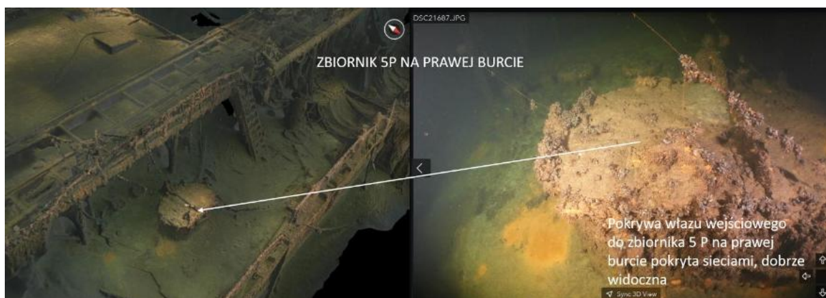
Rysunek 31. Dostęp do zbiornika ładunkowego 5P (źródło: opracowanie własne na podstawie Badania 2025-26)
