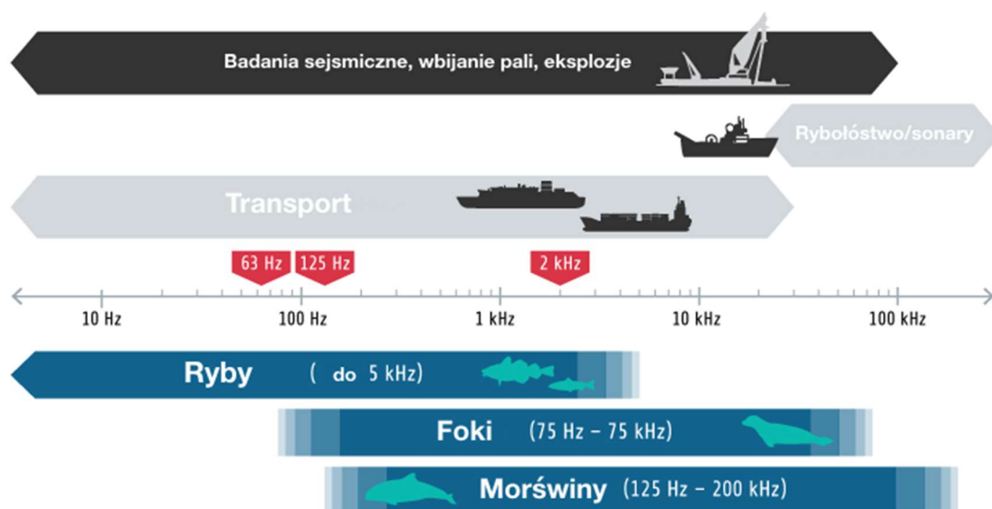
Ryc. 64. Przyrównanie dźwięku generowanego przez statki i urządzenia odpowiedzialne za hałas impulsowy do zakresu słuchu poszczególnych grup zwierząt.
