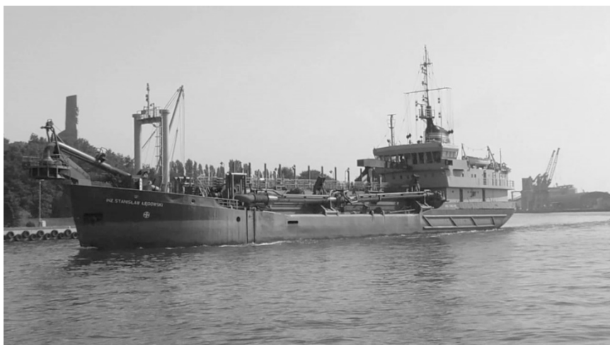
Fot. 7. Pogłębiarka nasiębierna Przedsiębiorstwa Robót Czerpalnych i Podwodnych w Gdańsku „Inż. Stanisław Łęgowski”
