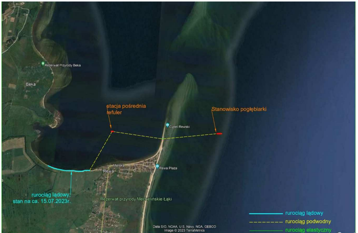
Rysunek 14 Refulacja Rewa etap II - prace w trakcie
