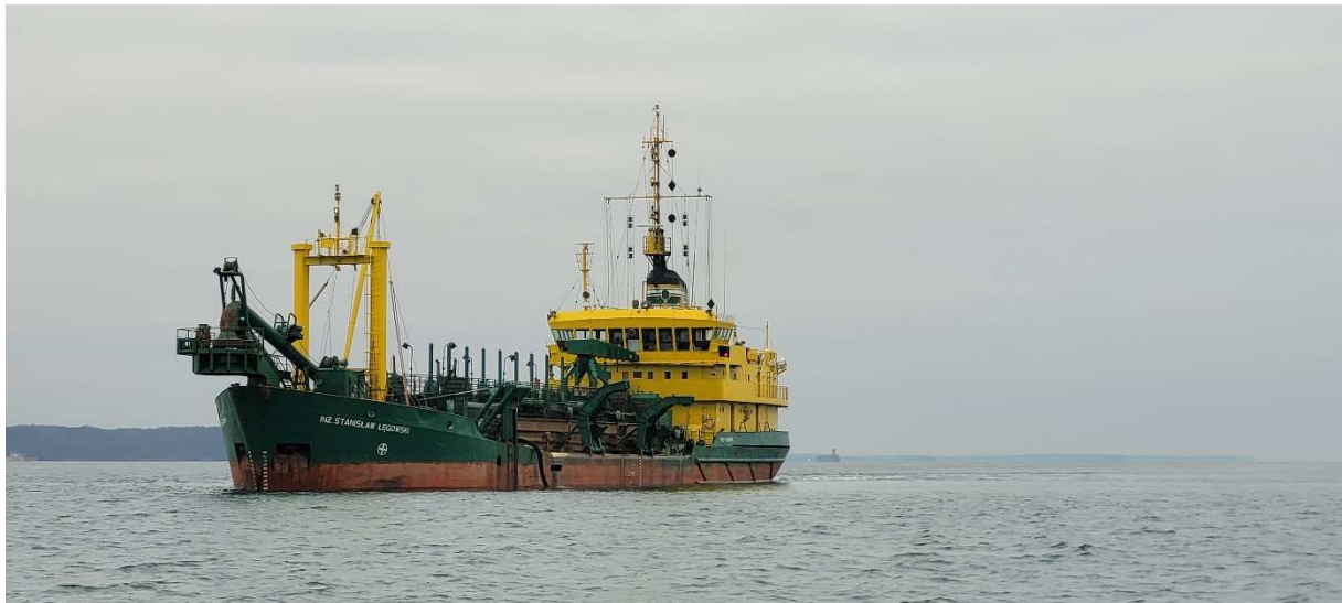
Rysunek 2 Pogłębiarka ssąco-nasiębierna Inż. Łęgowski podczas prac czerpalnych.
