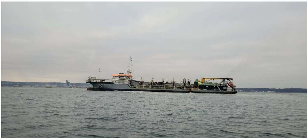
Rysunek 1 Pogłębiarka ssąco-nasiębierna Charlock podczas prac czerpalnych
