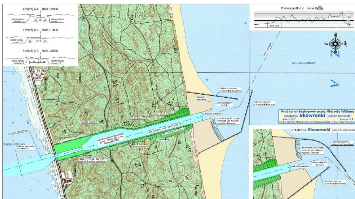
Rys. 25. Koncepcja kanału żeglugowego przez Mierzeję Wiślaną – wariant I „Skowronki” („Budowa kanału żeglugowego przez Mierzeję Wiślaną. Koncepcja techniczna i kosztowa kanału żeglugowego wraz z niezbędnymi budowlami hydrotechnicznymi” (2007) za Prognoza...
