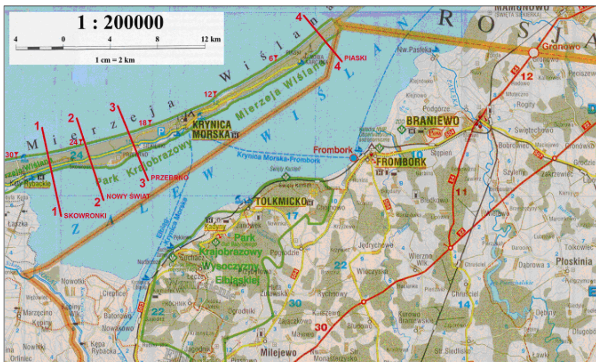
Rys. 24. Warianty I-IV lokalizacji kanału żeglugowego przez Mierzeję Wiślaną i toru wodnego na Zalewni Wiślanym (Źródło: Studium Wykonalności...)
