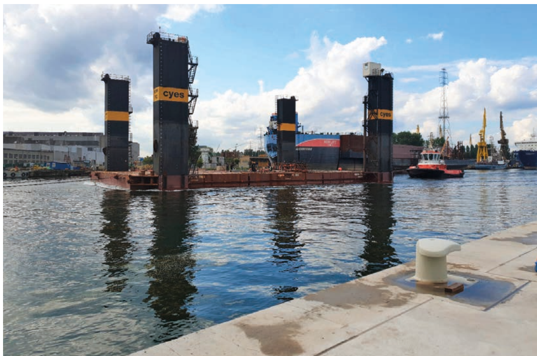
Rys. 21. Mobilizacja doku/pontonu zanurzalnego Cyes (długość 51 m, szerokość 34 m, wysokość burty 3 m, wysokość wież balastowych 20,5 m), widok na wyspę Ostrów od strony nabrzeża Przemysłowego, 21 sierpnia 2019 roku (fot. Łukasz Małkiewicz)
