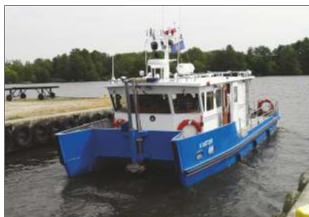
„Kastor” to katamaran hydrograficzny wyposażony w zainstalowaną na wysięgniku echosondę wielowiązkową obsługiwaną przez program SIS. "Kastor" is a hydrographic catamaran equipped with a multi-beam echosounder installed on the boom located between the bows, operated by the SIS software.
