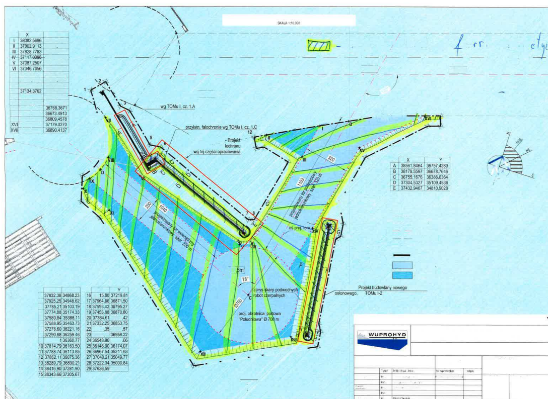
Mapa z zaznaczonym obszarem objętym przedmiotem zamówienia w tym obszarze stanowiącym podetap – obszar posadowienia modernizowanych falochronów – nowego falochronu ostonowego, falochronu stanowiącego wydłużenie istniejącego falochronu wyspowego i odcinka połączeniowego.
