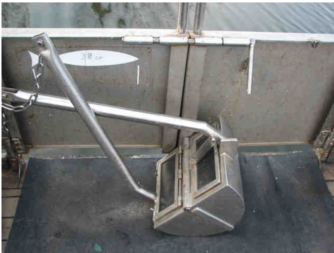
Fotografia V.5.1.2. Czerpak dna typu van Veen.
