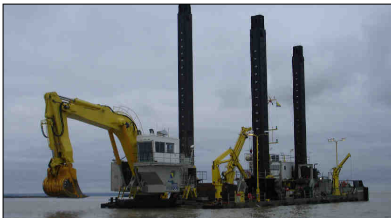
Rysunek II.5.3. Pogłębiarka łyżkowa ( http://www.boskalis.com ).
