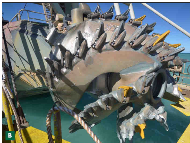
Rysunek 11.5.2. Spulchniacz mechaniczny pogłębiarek ssących ( http://www.boskalis.com ).
