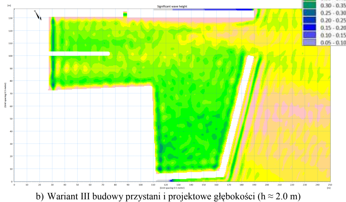
Rys. Z13. Porównanie obliczonych wysokości fal znacznych dla wariantu I i wariantu III. Parametry fal wejściowych: H_s = 0.70 m, T_p = 3.30 s, kierunek podchodzenia SSE, prawdopodobieństwo wystąpienia T_R = 100 lat.
